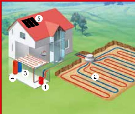
**Sole/Wasser-Wärmepumpe mit Flachkollektor**
