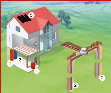
**Sole/Wasser-Wärmepumpe mit Tiefensonde**
