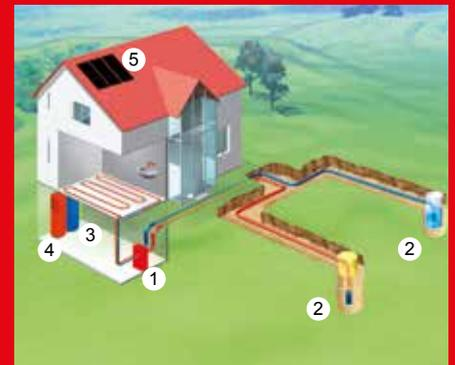
**Wasser/Wasser-Wärmepumpe mit Grundwasser**
