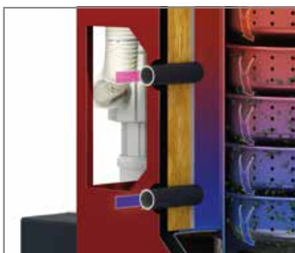
Les retours haute et basse température séparés augmentent l'efficacité de la technique de condensation.
