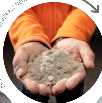
RECYCLES LINOLEUM-PULVER ALS NEUER ROHSTOFF
