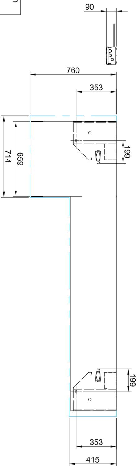
Die Befestigungspunkte und der Platzbedarf des Tores sind am Einbauport zu inspizieren. Die oberen Montagewinkel sollten an einem Betonsturz oder an einer Stahlkonstruktion verschraubt oder verschweißt werden.
