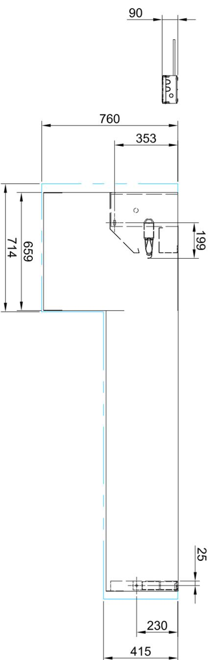
Die Befestigungspunkte und der Platzbedarf des Tores sind am Einbauort zu inspizieren. Die oberen Konsolen sollten an einem Betonsturz oder an einer Stahlkonstruktion verschraubt oder verschweißt werden.
