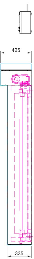
Die Befestigungspunkte und der Platzbedarf des Tores sind am Einbauort zu inspizieren. Die oberen Konsolen sollten an einem Betonsturz oder an einer Stahlkonstruktion verschraubt oder verschweißt werden.
