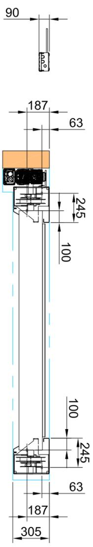
Platzbedarf für Montage Aufsteckantrieb
