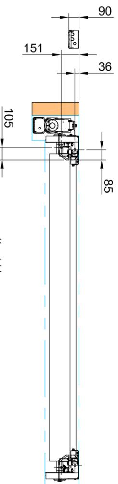
Die Befestigungspunkte und der Platzbedarf des Tores sind am Einbauort zu inspizieren. Die oberen Konsolen sollten an einem Betonsturz oder an einer Stahlkonstruktion verschraubt oder verschweißt werden.
