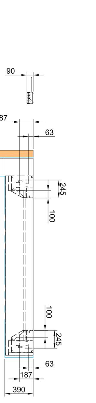
Die Befestigungspunkte und der Platzbedarf des Tores sind am Einbauort zu inspizieren. Die oberen Konsolen sollten an einem Betonsturz oder an einer Stahlkonstruktion verschraubt oder verschweißt werden.
