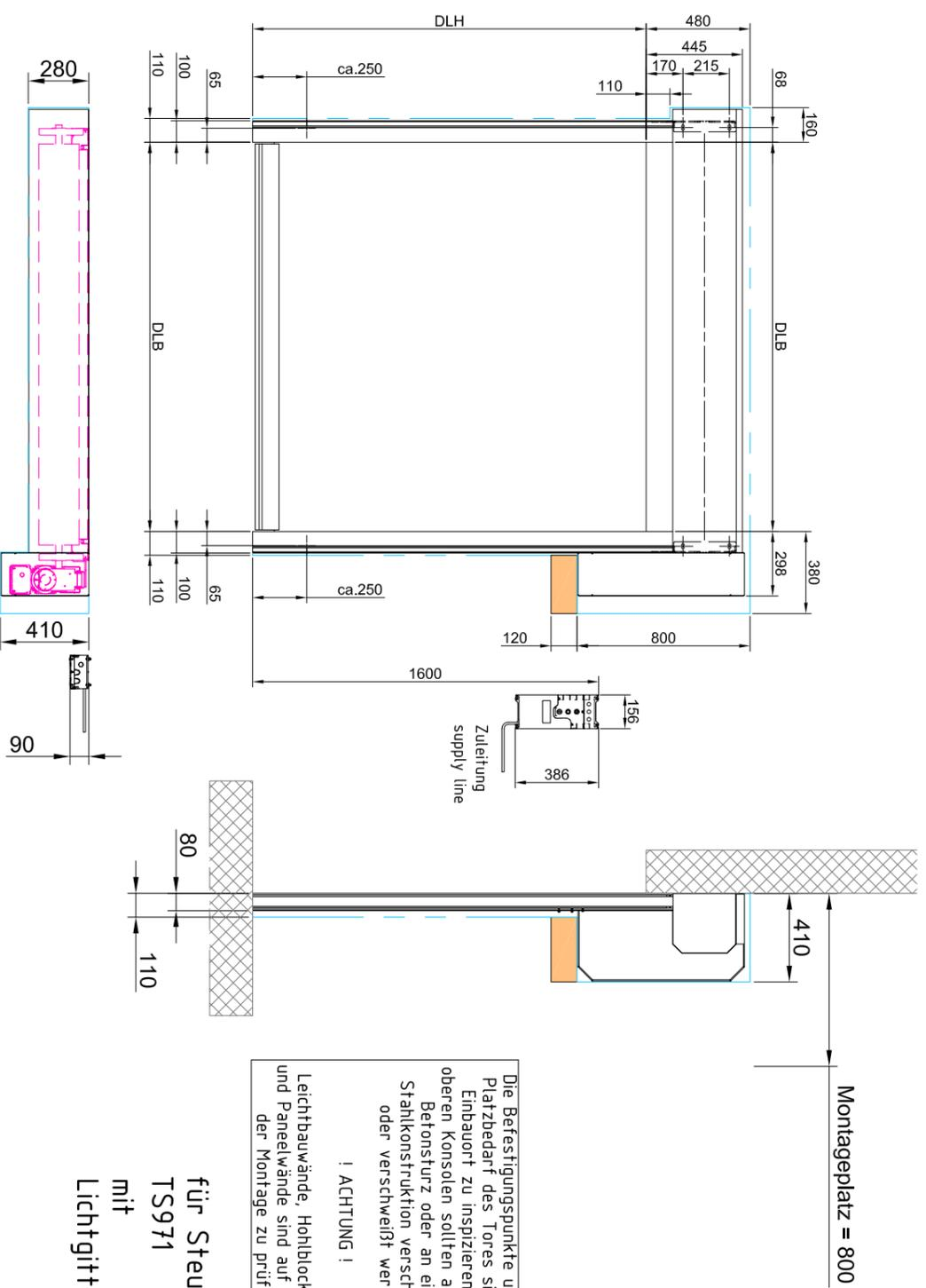
Die Befestigungspunkte und der Platzbedarf des Tores sind am Einbauort zu inspizieren. Die oberen Konsolen sollten an einem Betonsturz oder an einer Stahlkonstruktion verschraubt oder verschweißt werden.
