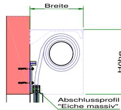
**Sonderlösung für Einbau in Zwischendecke**
