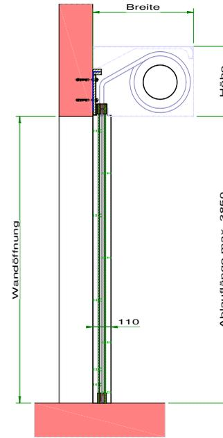
Textil Flexibler Feuerschutzabschluss geprüft nach EN 16034 und EN 1634-1
