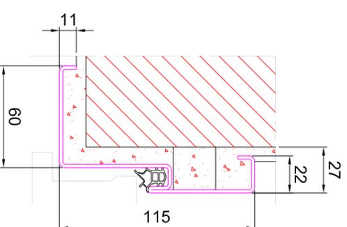
Eck zum Einmauern mit Dichtung
