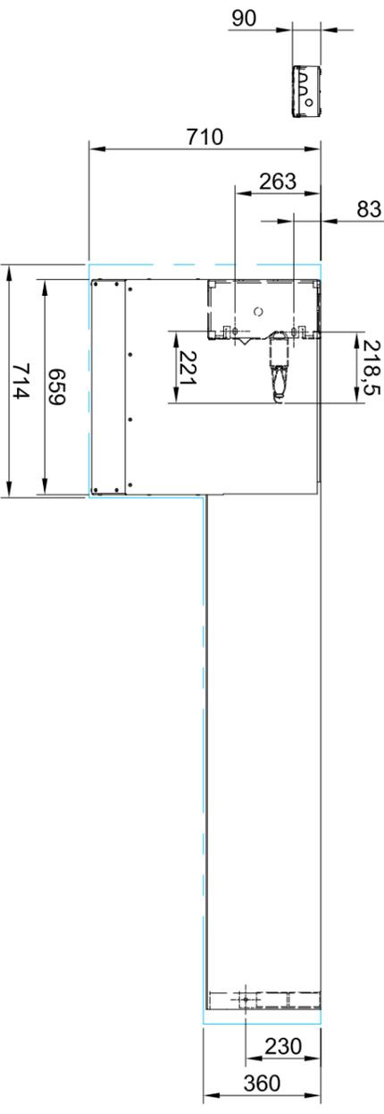
Die Befestigungspunkte und der Platzbedarf des Tones sind am Einbauort zu inspizieren. Die oberen Montagewinkel sollten an einem Betonsturz oder an einer Stahlkonstruktion verschraubt oder verschweißt werden.
