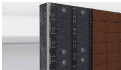
Fixer le profilé système avec un rivet aveugle en aluminium (n° d'art. 658) ou une vis en acier inoxydable A4 (n° d'art. 659-01).
