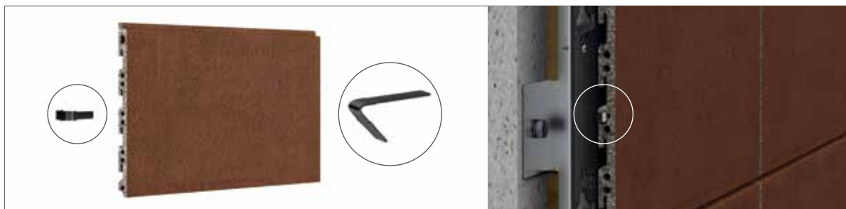
A la place du joint profilé, on peut utiliser en option une entretoise, n° d'art. 645 (pour joints ouverts)
