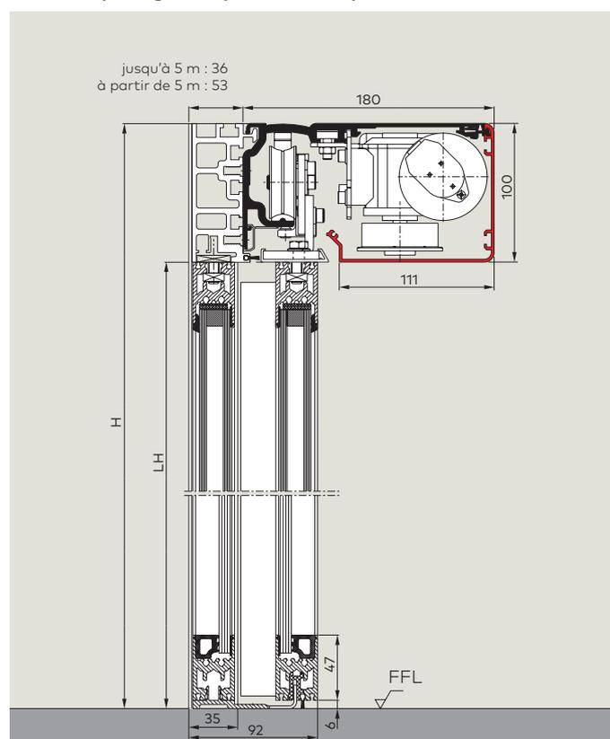
**Pose dans passage avec partiex fixes, opérateur 150 mm**
