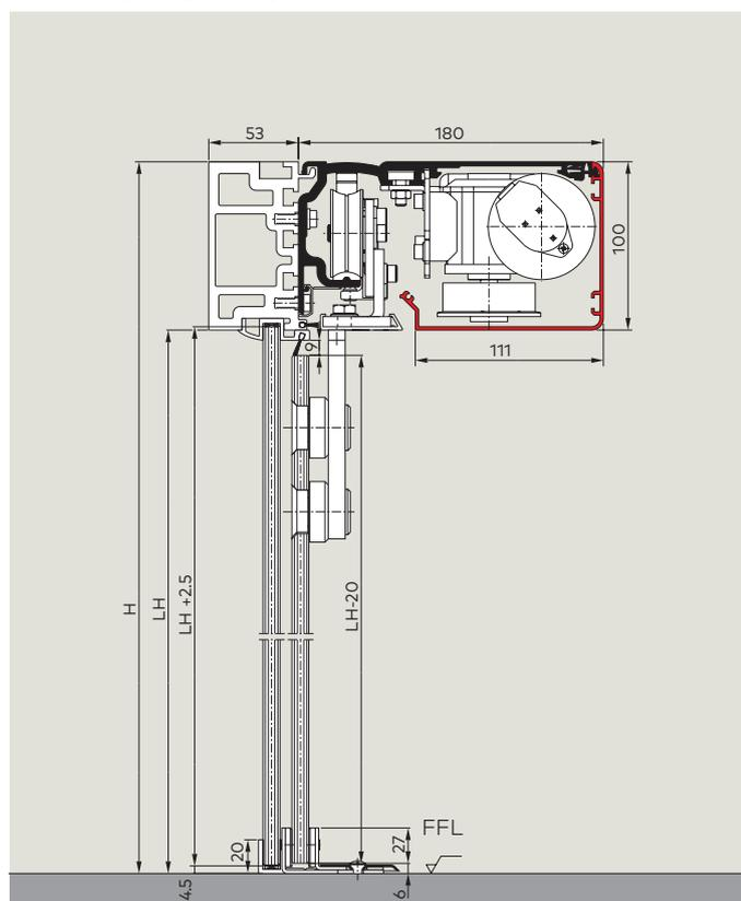
**Pose dans passage avec parties fixes, opérateur 150 mm**
