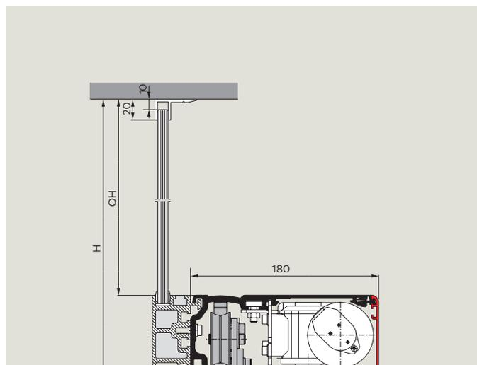
**Pose dans passage avec parties fixes, opérateur 100 mm**
