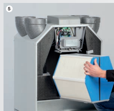
5 Zehnder Enthalpietauscher wieder in das Lüftungsgerät einsetzen. Aufkleber oben muss vorne sein.
