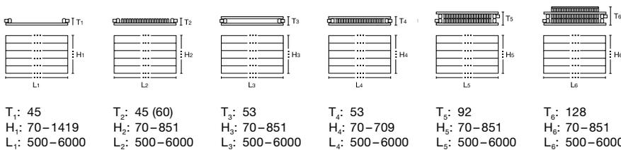
Sonderformen: gebogen, gewinkelt, optional mit integriertem Ventil (Completo-Ausführung)
