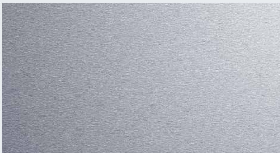
Acier inoxydable V2 A, 1.4301, grain 240
