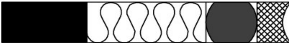
System 1: Vorkomprimiertes Dichtungsband, PU-Schaum, Hinterfüllschnur, Dichtungsmasse
