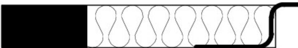
System 2: Vorkomprimiertes Dichtungsband, PU-Schaum, Folienband FI, Folienband Duo Easy 240
