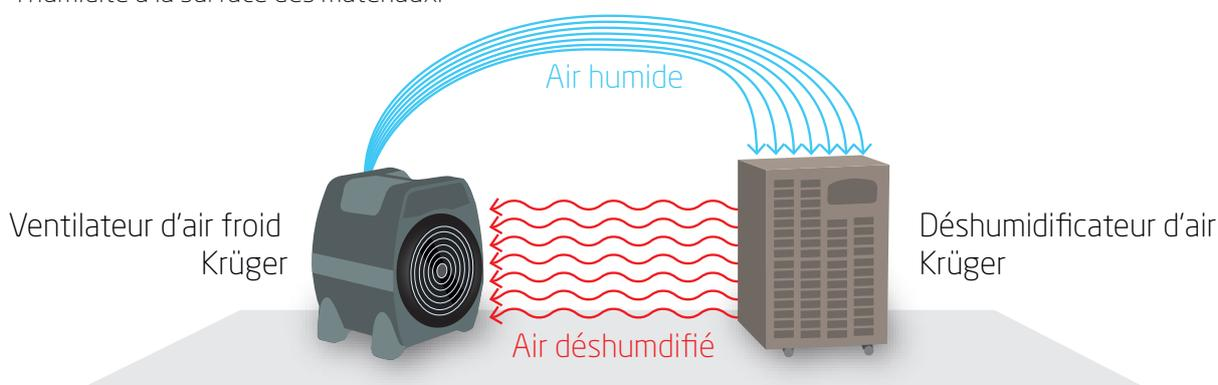
L'effet des ventilateurs d'air froid sur le processus d'assèchement est facile à comprendre. La circulation d'air favorise l'échange d'humidité à la surface des matériaux, le taux d'évaporation augmente. Les murs, plafonds et sols sèchent plus rapide-
