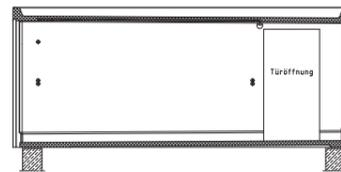
**Variante 2** mit Tür, auf linker Seitenwand, bestehend aus: Neon-Leuchte, Schalter und Schukosteckdose mit Deckel im Torbereich und Türbereich, Verteilerdose.
