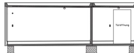
**Variante 3** für Garage mit Anbau, auf linker Seitenwand, bestehend aus: Neon-Leuchte in Garage und Anbau, Schalter und Schukosteckdose mit Deckel im Torbereich und Türbereich, Verteilerdose.
