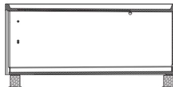
**Variante 1** für Garage, auf linker Seitenwand, bestehend aus: Neon-Leuchte, Schalter und Schukosteckdose mit Deckel im Torbereich, Verteilerdose.
