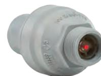
Das „Water Block“-Ventil ist eine Sicherheitsvorrichtung gegen Überschwemmung zur Steuerung des Durchflusses eines Wasservolumens zwischen 5 und 50 Litern. Beim Austritt von Wasser blockiert es, stoppt die Ausgabe und verhindert somit Überschwemmungen. Es verfügt über ein spezielles Rückschlagventil (Verschmutzungsschutz). Es ist so weit wie möglich vor dem Wasserleitungsnetz zu montieren. Anschlüsse: 8 mm oder 1/4"
