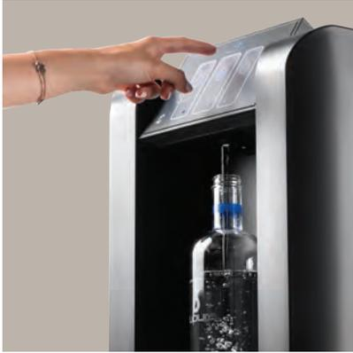
Die Bedienungen der Hydraxon „Touch Free“- Modelle werden über kapazitive Näherungsschalter aktiviert: Für die Wasserausgabe ist der Finger in 1,5 cm Entfernung vom Bedienfeld bis zum Ende der Ausgabe auf die Taste zu halten. Sobald der Finger entfernt wird, stoppt die Ausgabe automatisch.
