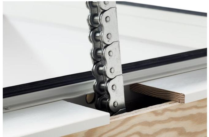
Le moteur des Lanterneaux Modulaires ouvrants est entièrement intégré dans la costière en bois. Le moteur n'est pas visible de l'intérieur lorsque le lanterneau est fermé, il n'y a donc aucune différence visuelle entre les lanterneaux fixes et ouvrants. La longueur de chaîne est de 260 mm pour une ouverture d'environ 190 mm. Les lanterneaux ouvrants répondent aux exigences de la norme harmonisée EN 60335-2-103(2015), voir commentaire ci-dessous pour la référence.
