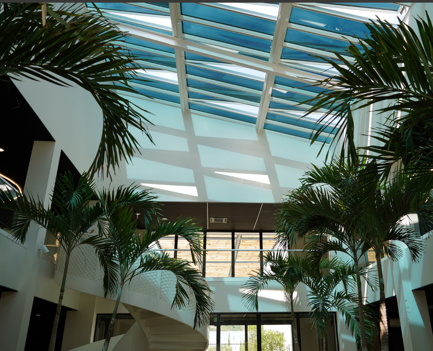
Siège Social Actis Isolation, Limoux, Frankreich. Ein Stufen-Lichtband, 54 Module inklusive elektrochromer Verglasung.
