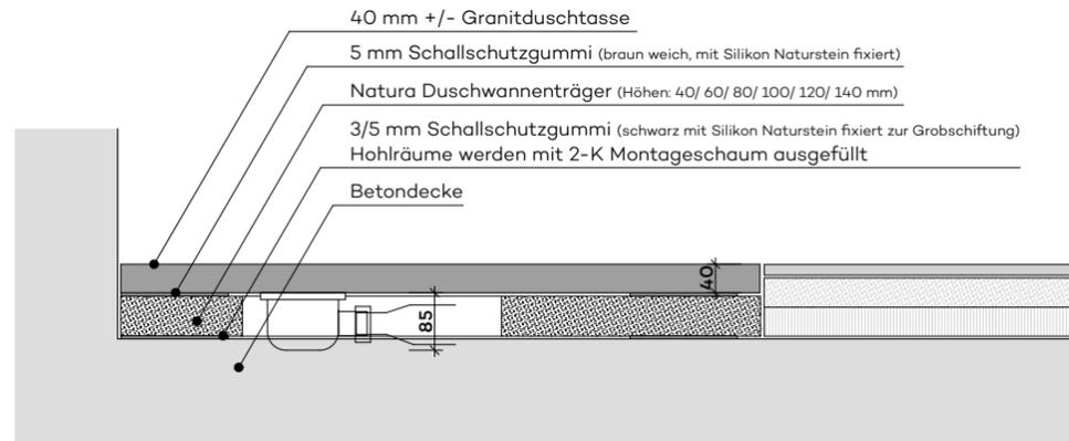
**Aufbau für erhöhte Schallschutzanforderungen**
