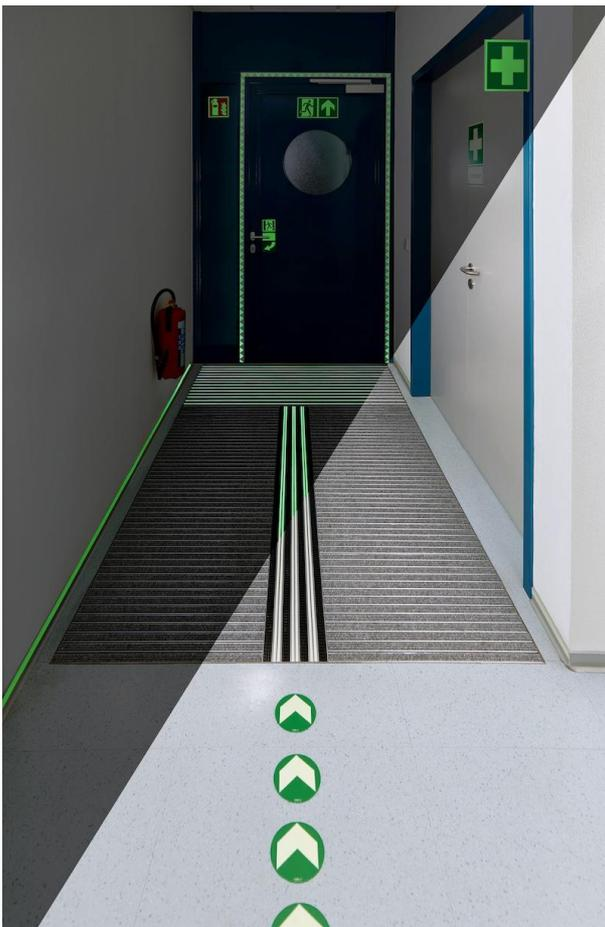
(BU): In Notfallsituationen mit einem Stromausfall ergänzt das nachleuchtende, bodengeführte Sicherheitsmatten-System Safe Clean TREND Fluchtwegeschilder und Leitlinien optimal.
