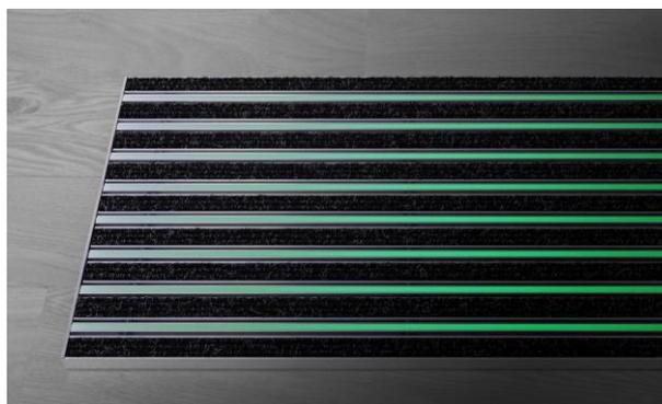
(BU): Der sicherheitsgebende Nachleuchteffekt basiert auf phosphoreszierenden Pigmenten mit einer Leuchtdichte nach DIN 67510, Teil 1 von 200 mcd/m<sup>2</sup> – 1 Minute nach Beleuchtungsausfall und mindestens 20 mcd/m<sup>2</sup> nach 10 Minuten.
