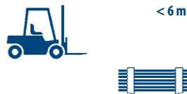
Les paquets de petites dimensions (moins de 6 m) peuvent être également soulevés et enlevés au moyen d'un élévateur, de manière appropriée en protégeant les fourches (d'un revêtement caoutchouc p.ex.). Les tôles profilées revêtues d'un feutre anticondensation ne peuvent être soulevées qu'au moyen d'élingues.
