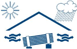
Une surface de stockage adaptée doit être mise à disposition. Il convient d'entreposer les paquets sur le chantier dans le sens longitudinal, au sec, légèrement inclinés, de manière à permettre l'écoulement de l'eau de pluie.
