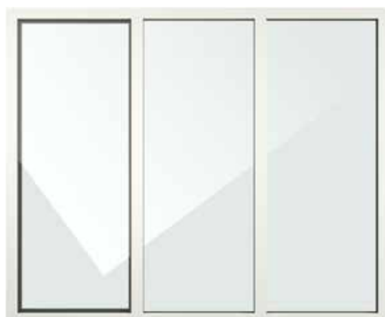
Fenêtre bandeau à trois ouvertures, dont un ouvrant Nova-line et deux fixes (type 324)
