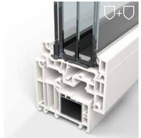
Vue en coupe d'une fenêtre avec triple vitrage isolant, verres extérieurs et intérieurs en exécution Multiprotect, configuration 44.2Sm-13-4F-13-66.2Sm
