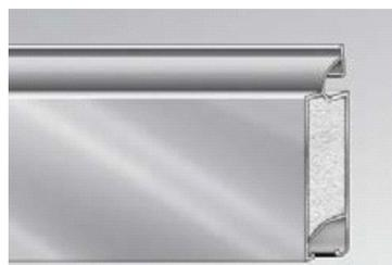
Alu-Lamellen, stranggepresst, 1.2 mm, doppelwandig 1.2 mm, wärmedämmend, ca. 20 mm dick, rechts und links mit Gleitstücken, zwischen den Lamellen schalldämmende Gummiprofile.
