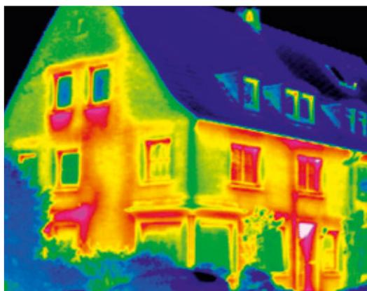
Les ponts thermiques représentent l'un des plus grands points faibles de l'isolation thermique intérieure. Un courant thermique élevé, et les faibles températures de surface qui en découlent sur le côté intérieur, peut générer la formation de condensation et de moisissures à ces endroits critiques. Dans le domaine de l'isolation thermique intérieure, les principaux points faibles sont:
