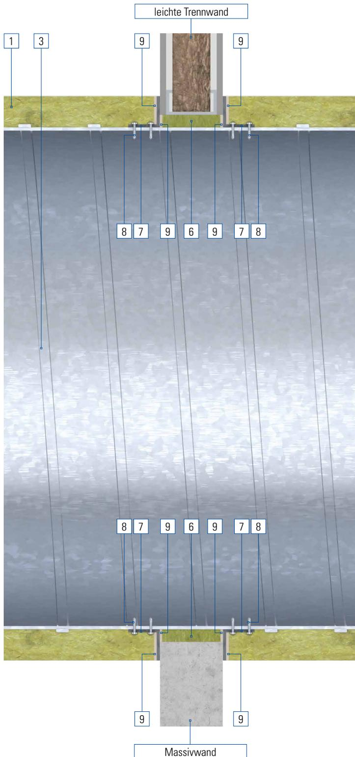
Nach der Montage der Rohrleitung wird im Bereich der Wanddurchführung der verbleibende Restspalt zwischen Rohrleitung und der Bauteilöffnung mit Flumroc FMI 500 FP lose ausgestopft. Der Restspalt sollte umlaufend max. 30 mm betragen.
