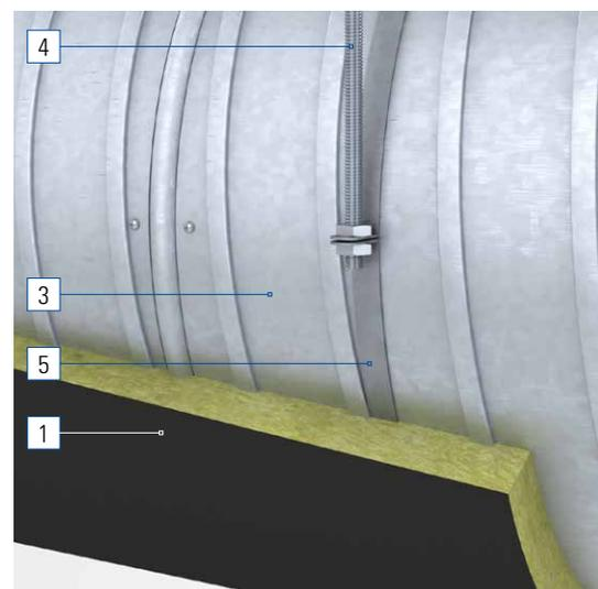
Ein Ausschneiden im Bereich von Rohrverbindungen (Nippel / Muffe) und Abhängungen (Rohrschelle) ist nicht erforderlich. Bei Abhängungen ist die Dämmmatte entsprechend der Situation einzuschneiden. Es ist darauf zu achten, dass die Stösse sauber aneinanderliegen und vollständig geschlossen sind. Bei Erfordernis ist die Stossstelle zusätzlich mit Tellerschweisstiften zu fixieren. Rohrschellen und Nippel dürfen überdämmt werden.
