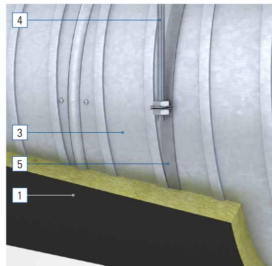
Aucune découpe au niveau des raccords de conduits (raccords/manchons) et des suspensions (colliers de serrage) n'est nécessaire. Pour les suspensions, le matelas isolant doit être découpé en fonction de la situation. Il convient de veiller ici à ce que les joints soient bien aboutés et que les interstices soient intégralement fermés. Si nécessaire, on fixera en sus les joints avec des pointes à souder. Les raccords et les colliers de serrage peuvent être recouverts.
