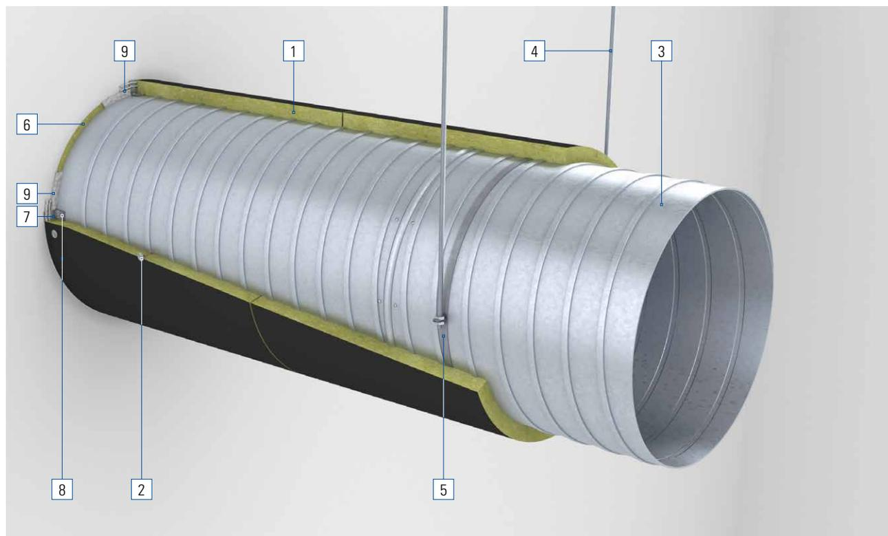
La mise en œuvre de Flumroc FMI 500 FP est remarquablement simple. L'isolation monocouche est directement appliquée sur le conduit et permet de se contenter de suspensions élancées grâce au faible poids du revêtement.
