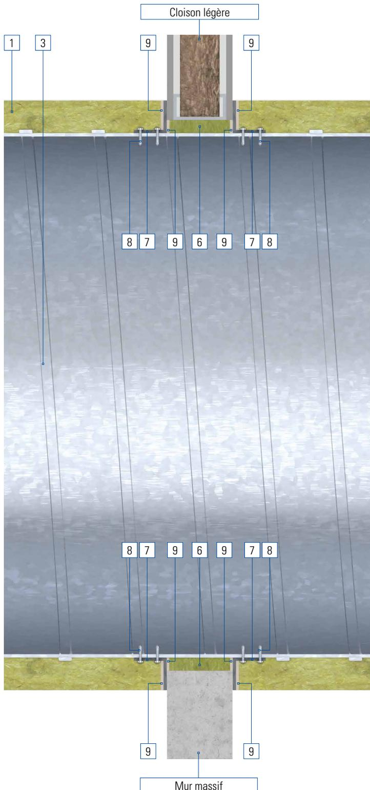
Après le montage du conduit, l'interstice restant entre le conduit de ventilation et l'ouverture dans l'élément de construction est rempli en vrac avec du Flumroc FMI 500 FP. Cet interstice ne devrait pas excéder 30 mm sur tout le pourtour.
