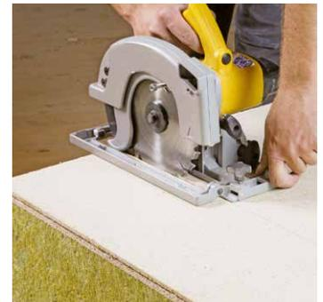
*Einfaches Zuschneiden mit der Handkreissäge*
