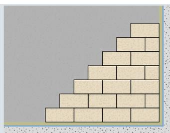
Die fugenversetzte Verlegung garantiert eine homogene Dämmschicht. Zwischenräume zu Mauern werden nachträglich mit Steinwollstreifen gefüllt. Wahl der Luftdichtigkeitsschicht entsprechend den baulichen Gegebenheiten und der geplanten Nutzung.
