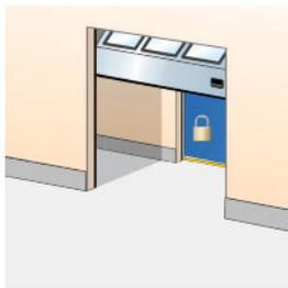
Entwickelt für Klimasteuerung oder Sicherheit. Wenn Tor A geöffnet ist, kann Tor B nicht geöffnet werden. Wenn Tor B geöffnet ist, kann Tor A nicht geöffnet werden. Ein so gesperrtes Tor kann einen Öffnungsbeehl speichern, sofern über einen Mikroschalter ausgewählt.
