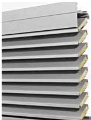
DucoGrille Acoustic 75 Z und DucoGrille Acoustic 75 L sind schallgedämmte Lüftungsgitter für Wandeinbau hergestellt aus Alu-Strangpressprofilen. Mit einem einzigen Lamellentyp sind zwei ästhetische Anwendungen möglich : Z und L. Die Lamellen sind an der Innenseite mit schalldämmender, nicht brennbarer Mineralwolle versehen. Die Aluminiumlamellen werden auf Lamellenhalter aus Kunststoff geklickt.
