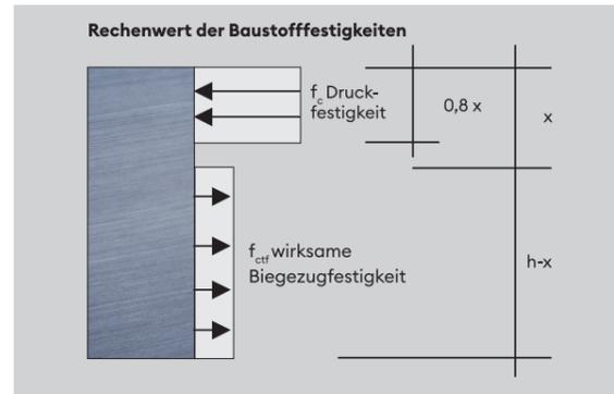
Die zentrische Nachrisszugfestigkeit wird für Nachweise im Grenzzustand der Tragfähigkeit herangezogen. Bei der Querschnittsbemessung darf, neben der Tragfähigkeit auf Druck, dem Beton auch ein Traganteil auf der Zugseite, im gerissenen Zustand, ohne konventionelle Bewehrung zugeordnet werden. Die zentrische Nachrisszugfestigkeit wird bei Presyn a-plus 05, 07 zusätzlich zu den bekannten Betoneigenschaften gewährleistet.
