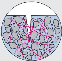
Das dreidimensional armierte Gefüge schränkt bereits die Mikrorissbildung ein. Das Resultat ist ein kompakter, resistenter Beton mit entsprechenden Mehrwerten.
