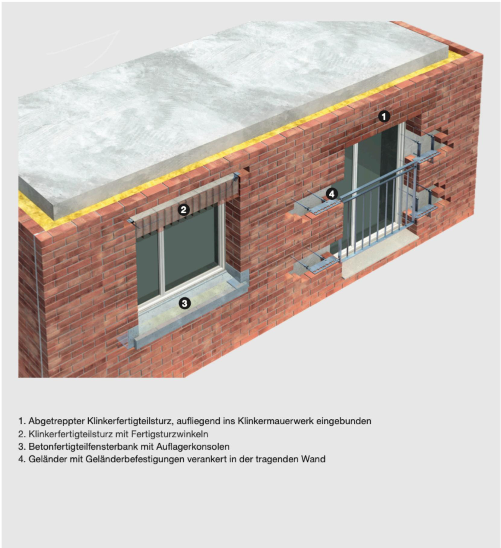
1. Abgetreppter Klinkerfertigteilsturz, aufliegend ins Klinkermauerwerk eingebunden
