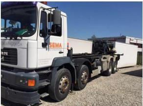
Garage wird mit dem Versetz-Fahrzeug millimetergenau abgeladen
