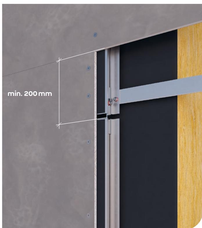
Im Profilstossbereich sind je Profilaufleger mindestens zwei Befestigungsschrauben für die MARMOtec board cement/glass zu installieren.
