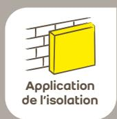
Les panneaux isolants sont posés horizontalement, en quinconce du bas vers le haut. Les panneaux d'isolation thermique doivent être positionnés bord à bord, de façon plane, sans décalages ni joints. Pour poser les panneaux d'isolation thermique, appliquer le mortier-colle sur les panneaux isolants sous la forme de bandes dans les bords.
