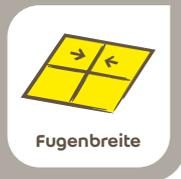
Die Fugenbreiten von starren Fugen stehen in engem Zusammenhang mit der Dampfdiffusionsoffenheit des Belages, dem Plattenformat, dem Modulmass\*, dem Hellbezugswert des Belages und dem gewählten Dämmsystem.
