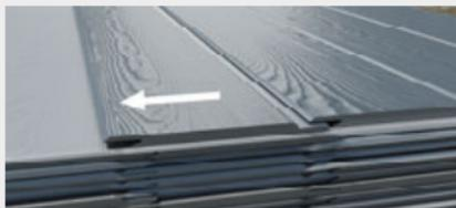
Hardie® VL Plank Platten werden ineinander gesteckt geliefert. Fassadenpaneele sind bei der Entnahme von der Palette seitlich herauszuziehen und erst dann anzuheben.
