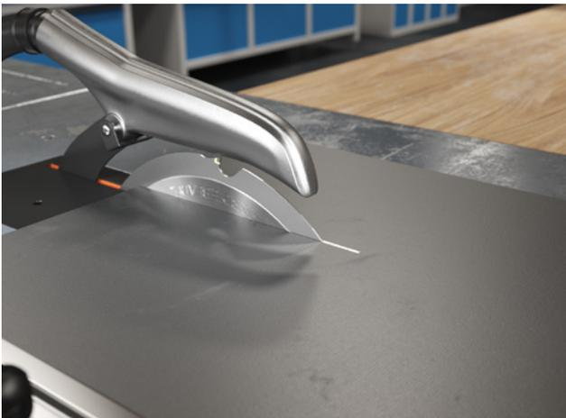
Vorschub und Schnittgeschwindigkeit sollten je nach verwendeten Sägen und Sägeblättern optimiert werden. Generell ermöglichen höhere Schnittgeschwindigkeiten eine bessere Schnittkantenqualität.
