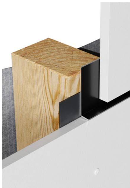
Für die Ausbildung der horizontalen Fugen können unterschiedliche Profile verwendet werden, die nach Anleitung jeweiliger Hersteller ausgeführt, bzw. eingebaut werden müssen.
