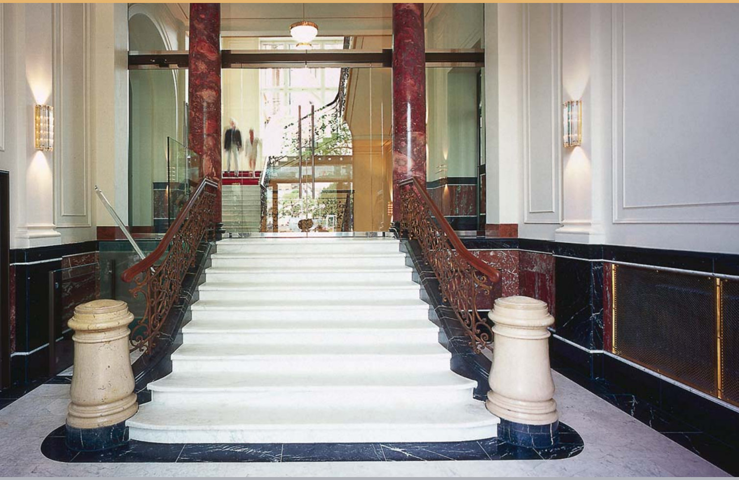
Hessische Staatskanzlei Wiesbaden, reversible Farbfassung der Stuckflächen mit Histolith Emulsionsfarbe
