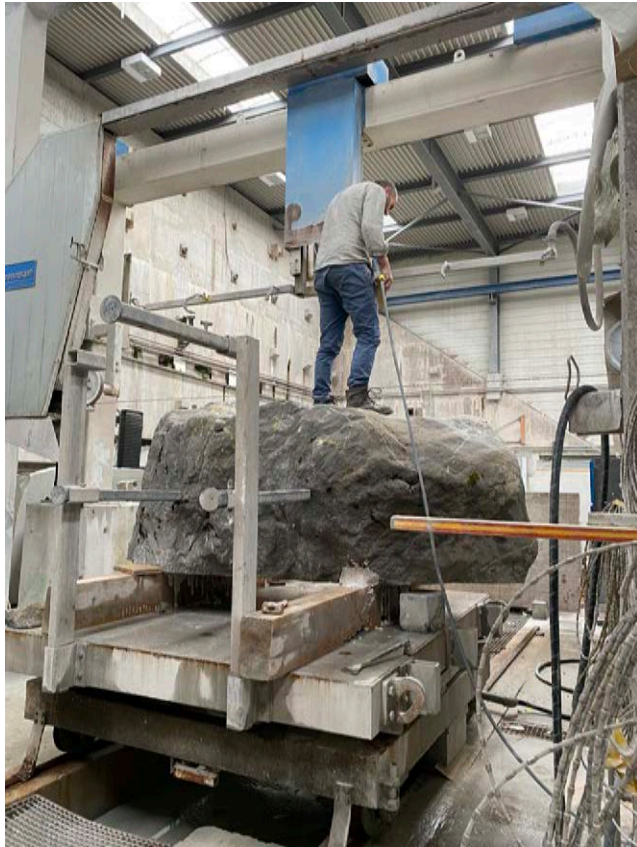
Im Massstab 1:1 entwerfen: die Steine werden Schnitt für Schnitt in Möbel verwandelt
