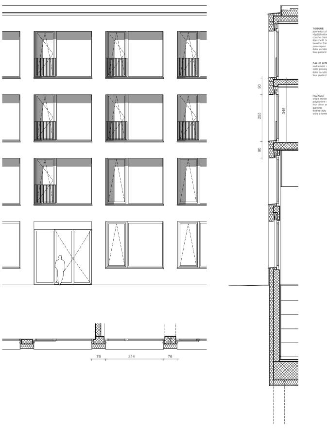
panneaux photovoltaïque régétalisation extensive couche drainante étancheité bi-couche solation thermique care-vapeur talle en béton armé
