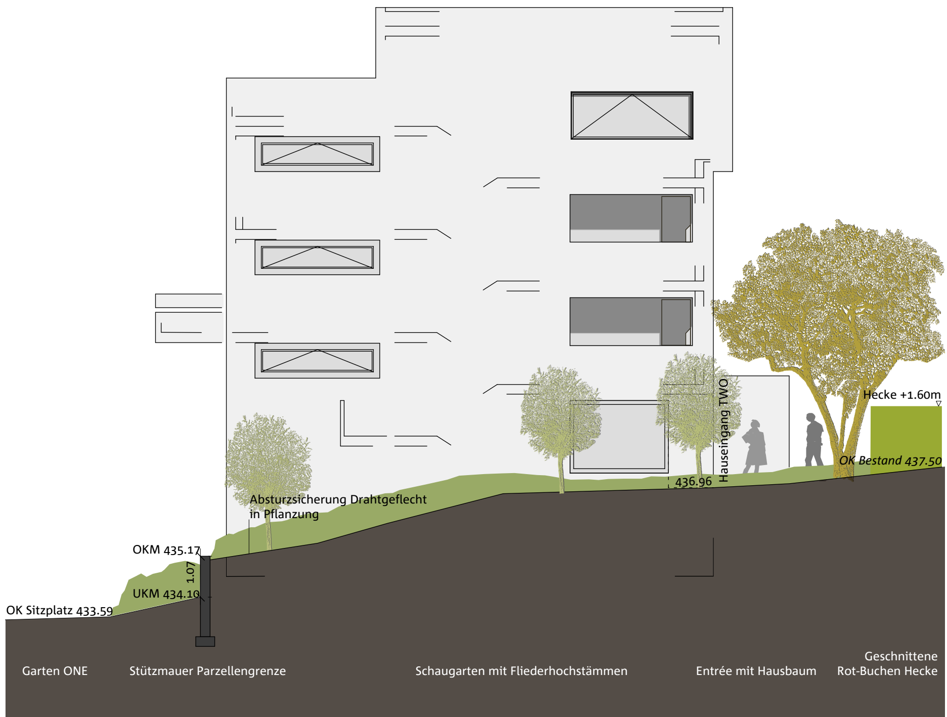
Schnitt BB', Ansicht Westfassade TWO, M 1:100
