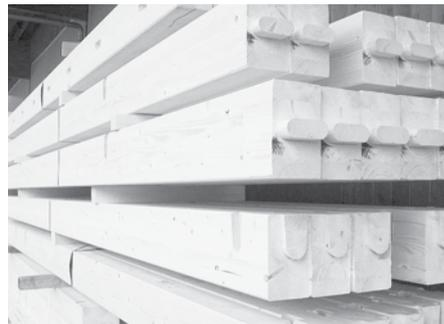
Abb. 115, Maschinell gefertigte Holzverbindungen.
