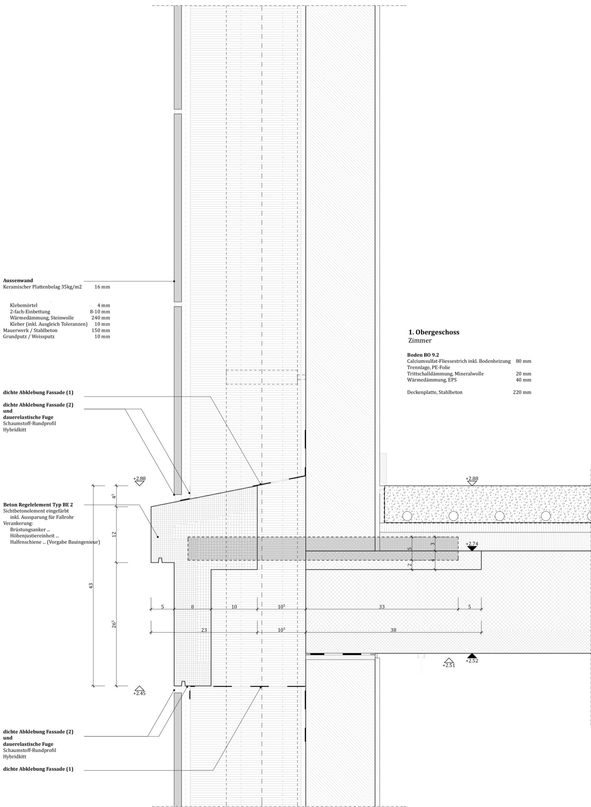
**dichte Abklebung Fassade (2) und dauerelastische Fuge**
