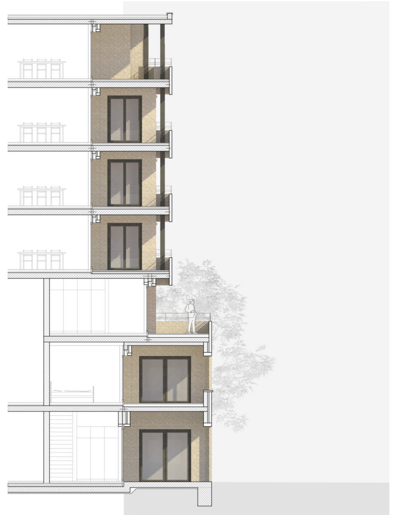
Fassadenschnitt durch Balkone | 1 : 100
